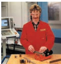
Ke srážení a odhrotování lze použít doby chodu stroje
